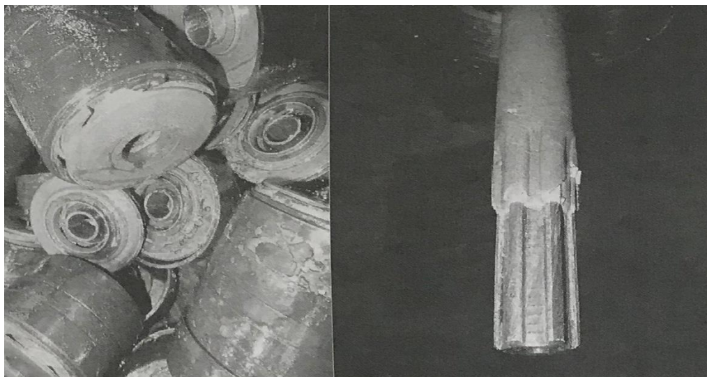
Рисунок 3 - Аппараты центробежного насоса и вал, покрытые отложениями солей (карбонат кальция).
