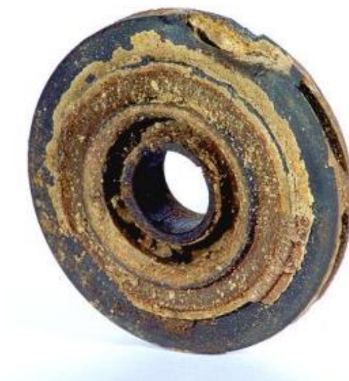
Рисунок 2 – Отложения солей на рабочем колесе ЭЦН.
