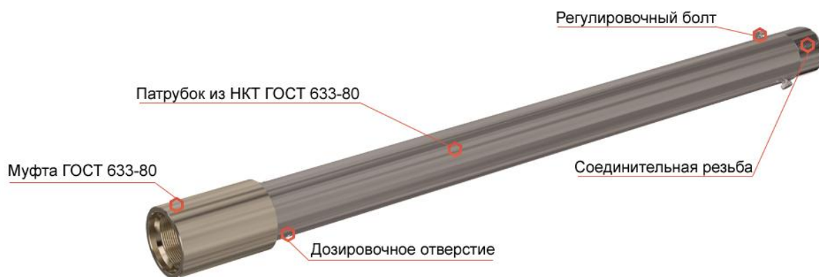
Рисунок 13 – Погружной скважинный контейнер
