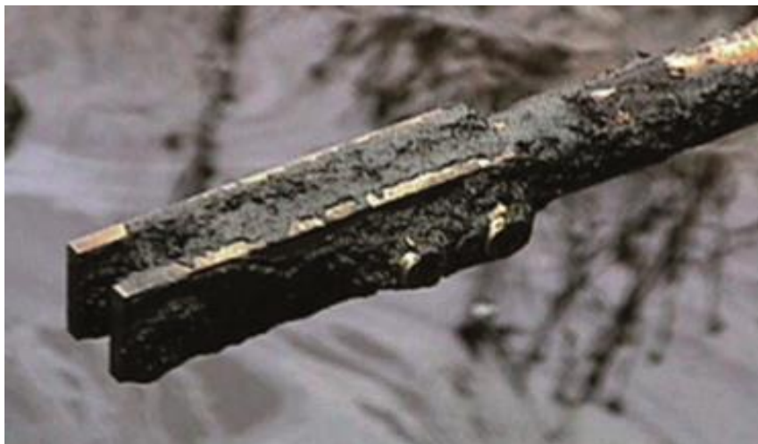
Рисунок 1 – Отложения парафинов на образцах контроля скорости коррозии весовым методом [2]
