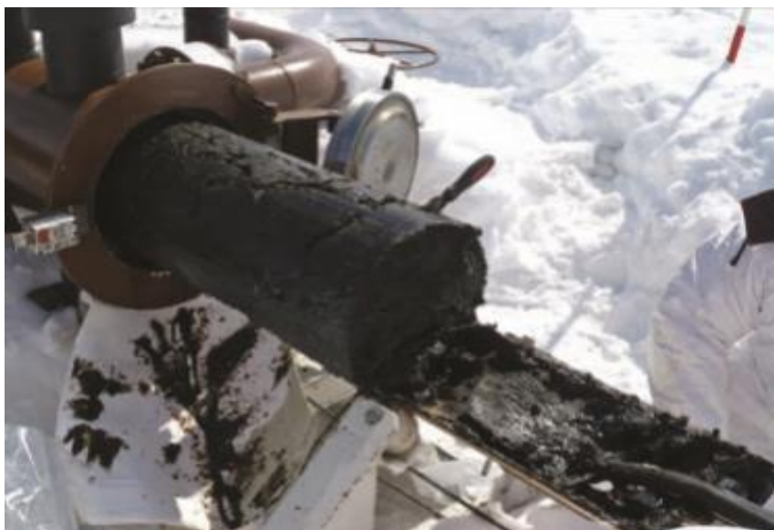
Рисунок 2 – Часть парафиновых отложений, вынесенных скребком в камеру приема из подводного трубопровода [2]
