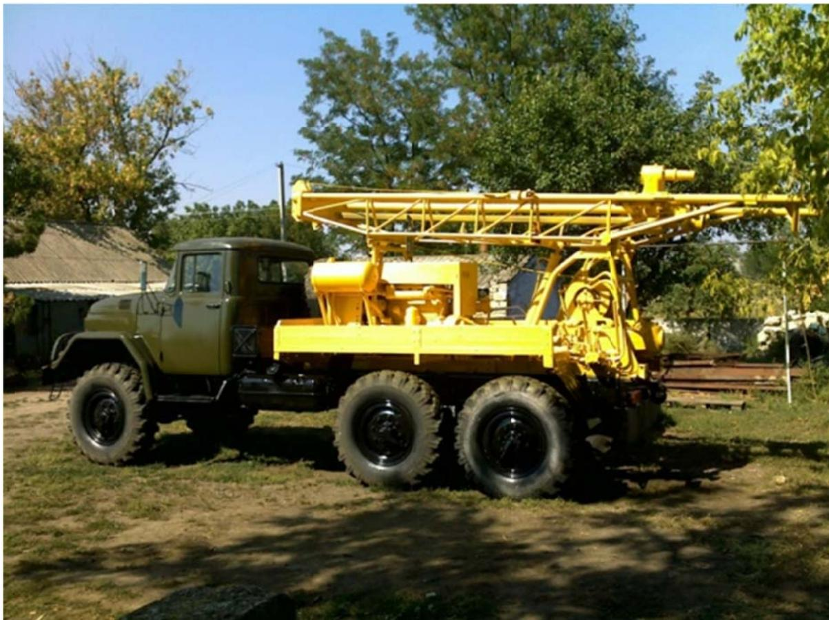
*Рис. 3.2 Буровая установка УГБ-1ВС на базе автомобиля Зил 131.*
