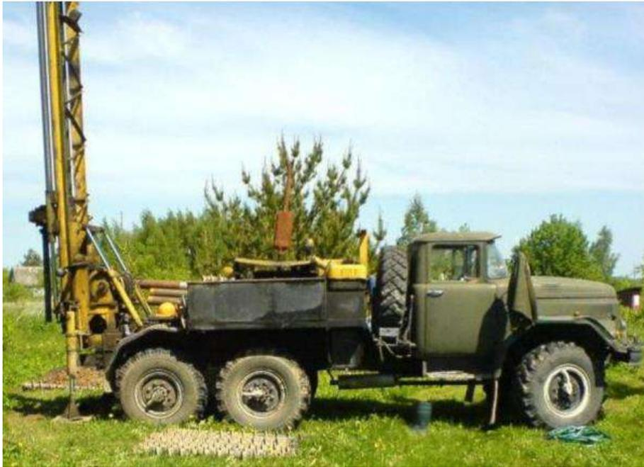
Рисунок 3.3 – Буровая установка ПБУ 2 на базе автомобиля ЗИЛ
