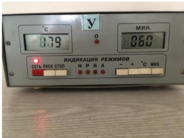
Рисунок 2.9 – Блок управления термошкафом
