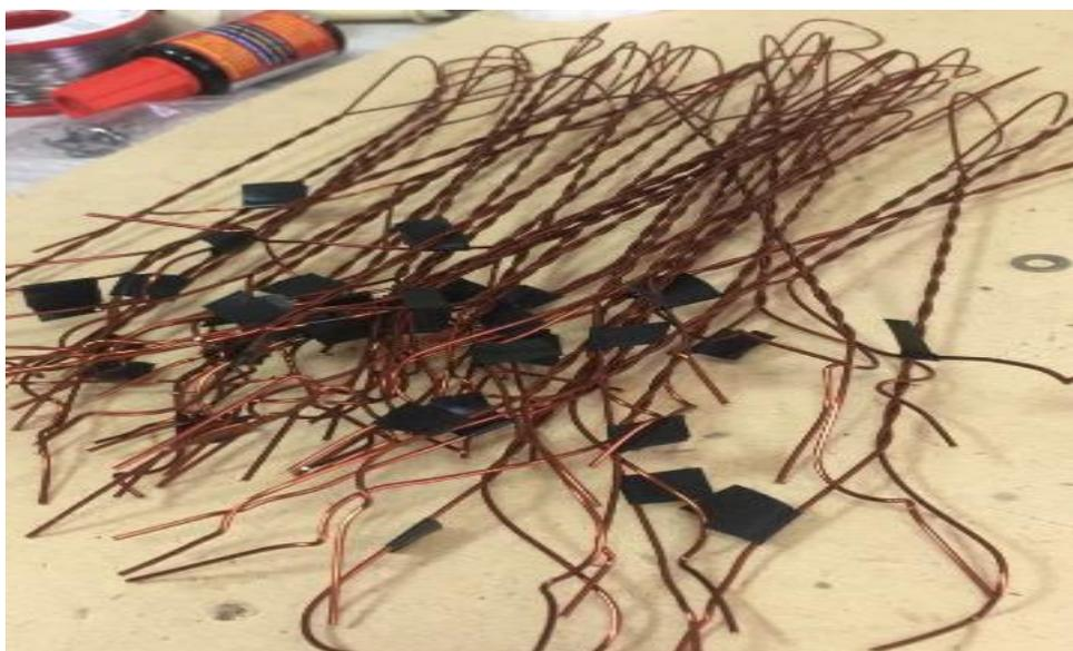
Рисунок 2.3 – Общий вид образцов эмалированного провода.
