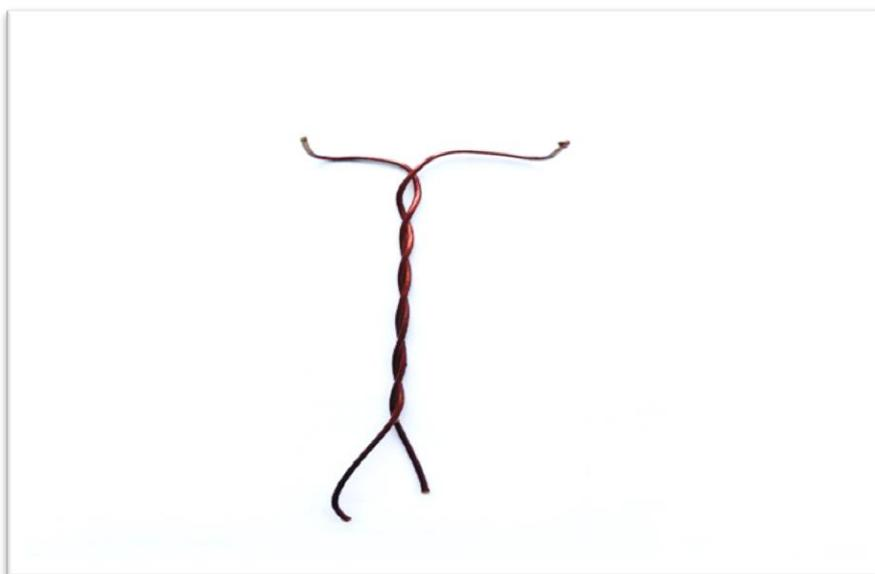
Рисунок 2.5-Образец испытуемой скрутки
