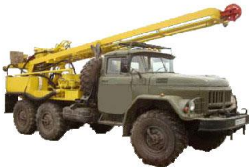
Рисунок 3.3.2.1 – Самоходная буровая установка УРБ-2А-2
