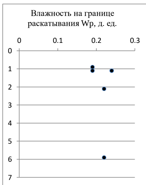
Рисунок 6 – Изменение влажности на границе раскатывания супесчаного заполнителя галечникового грунта (ИГЭ-3) по глубине
