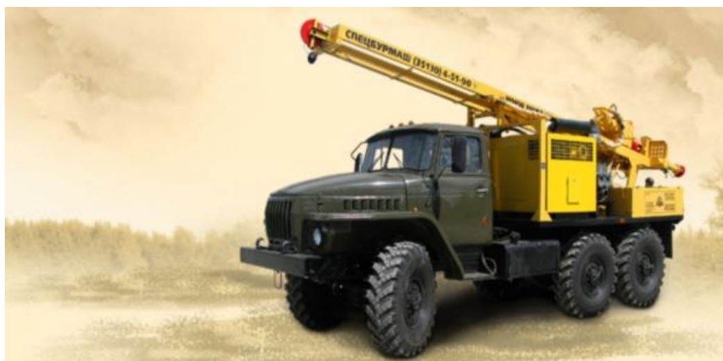
Рисунок 3.5 Буровая установка УРБ-2А-2 на базе УРАЛ
