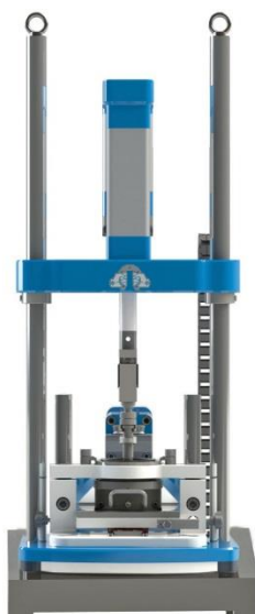
Рисунок 3.9 Установка одноплоскостного среза фирмы «Геотек»
