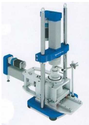
Рисунок 3.8 Автоматизированный испытательный комплекс АСИС одноосного сжатия для скальных грунтов фирмы «Геотек»
