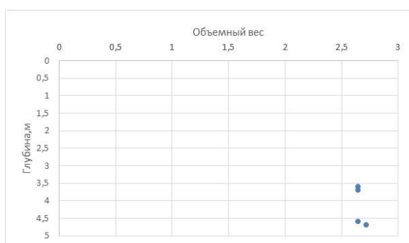
Рисунок 2.11. Изменение объемного веса гранито-гнейса (ИГЭ-3) по глубине
