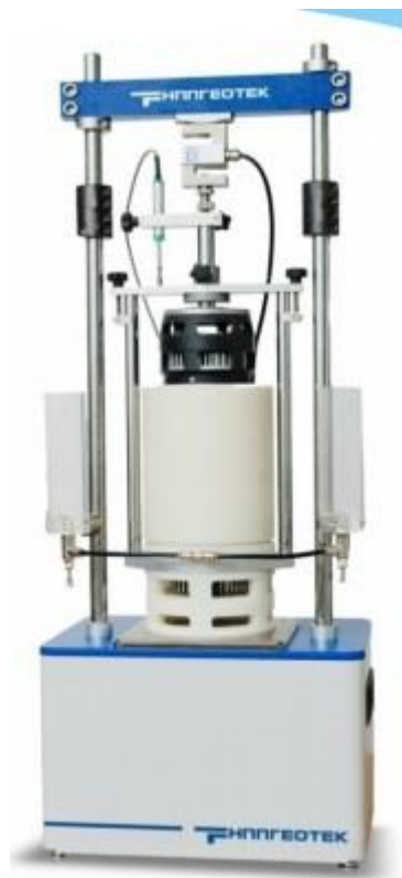
Рисунок 3.8 Испытательный комплекс АСИС «Криология» фирмы «Геотек»
