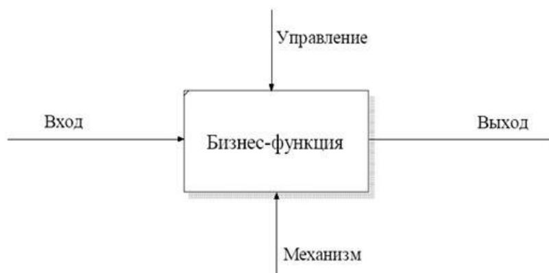
Рисунок 7 – Графические элементы диаграмм нотации IDEF0
