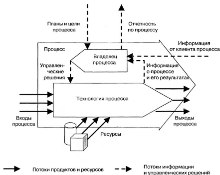
Рисунок 3 – Концептуальная схема управления процессом
