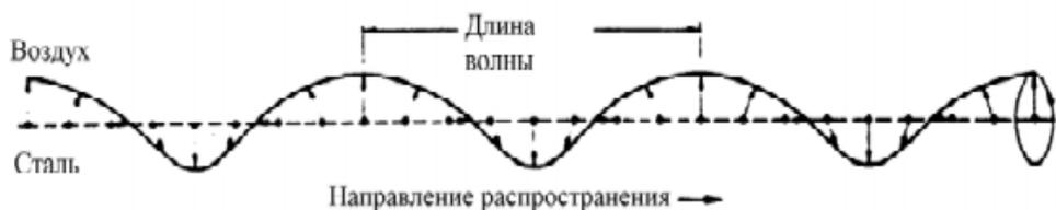
Рисунок 2.6 – Распространения поверхностных волн.
