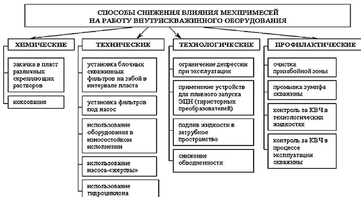
Рисунок 3.5. Способы снижения влияния мехпримесей на работу внутрискважинного оборудования.
