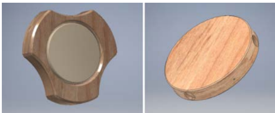
Рисунок 29. Универсальная цилиндрическая форма вкладыша, смоделированная в программе Autodesk Inventor
