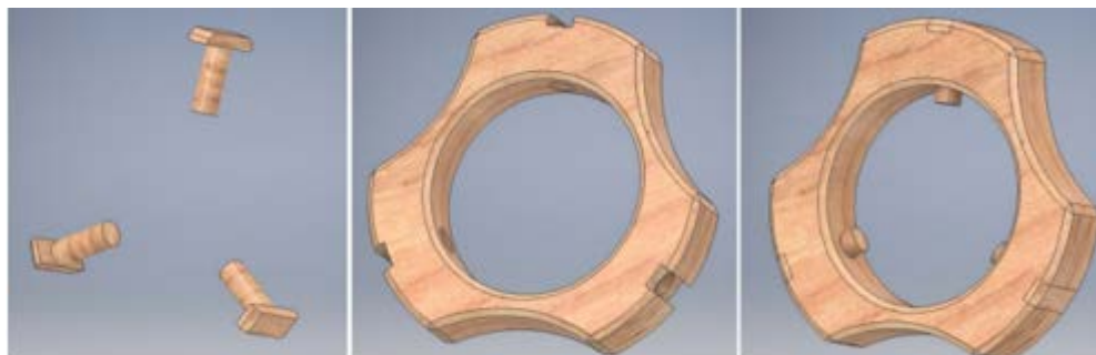
Рисунок 27. Четвертый вариант со тремя шкантами
