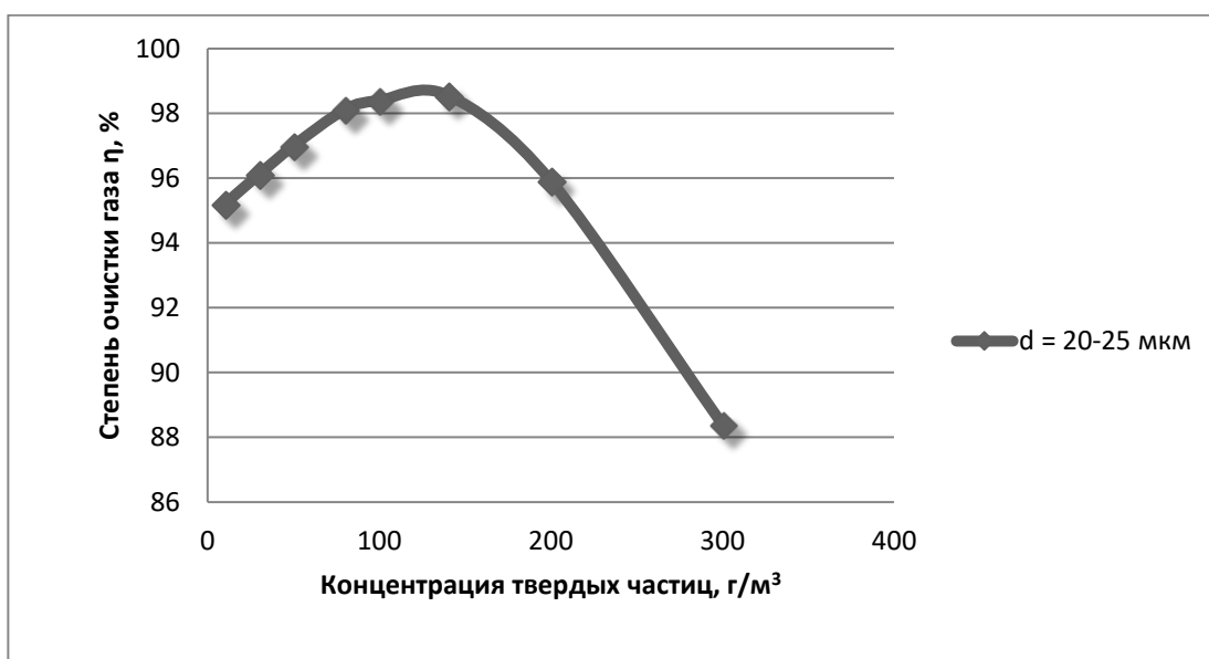
Рисунок 13 – Зависимость степени очистки газа от концентрации песка в запыленном газе
