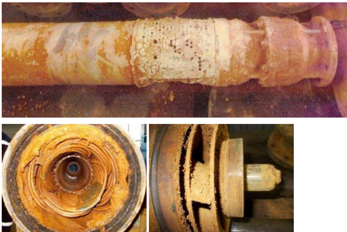
Рисунки 10,11,12 Отложения оксидов железа на насосе.
