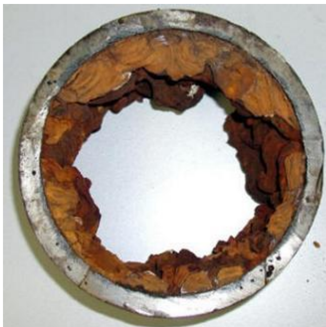
Рисунок 13 Отложения оксидов железа фильтре скважины
