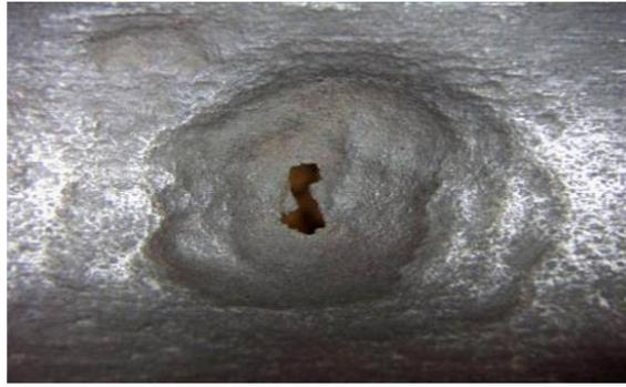
Рис. 1. Поверхность трубы, подверженная коррозионному биоповреждению
