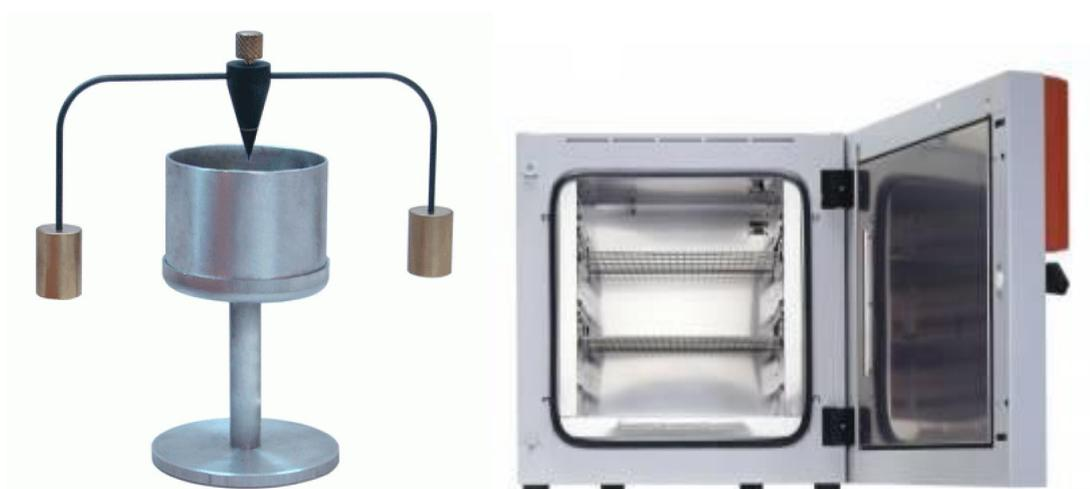
*Рисунок. 3.3.4.2 – Балансированный конус и сушильный шкаф.*
