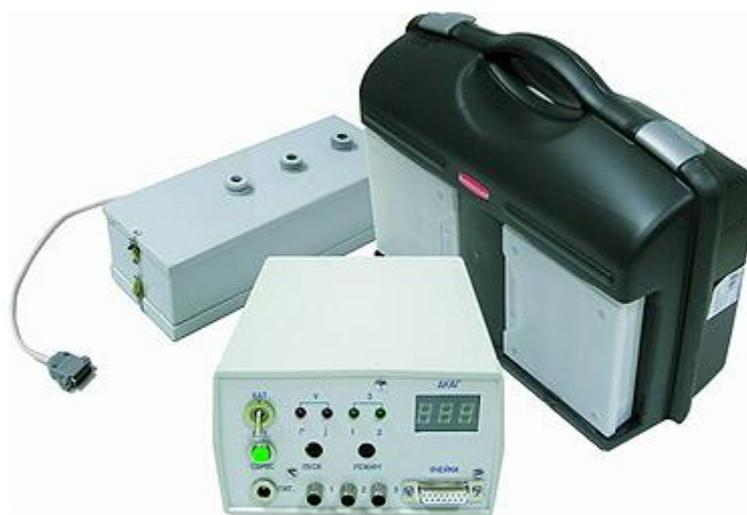
*Рисунок 3.3.4.11 – Прибор для определения коррозионной активности грунтов*
