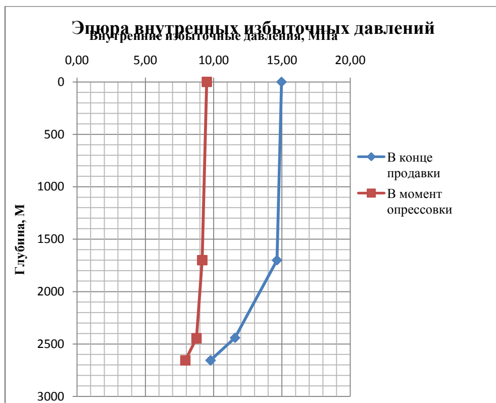
Рисунок Ж.2 – Эпюра внутренних избыточных давлений
