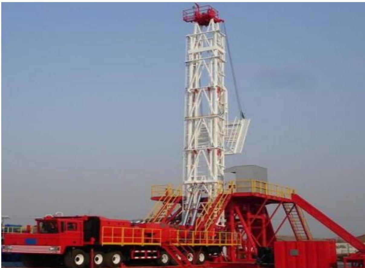
Рисунок 14 – Мобильная буровая установка Rig ZJ 30 в смонтированном состоянии.
