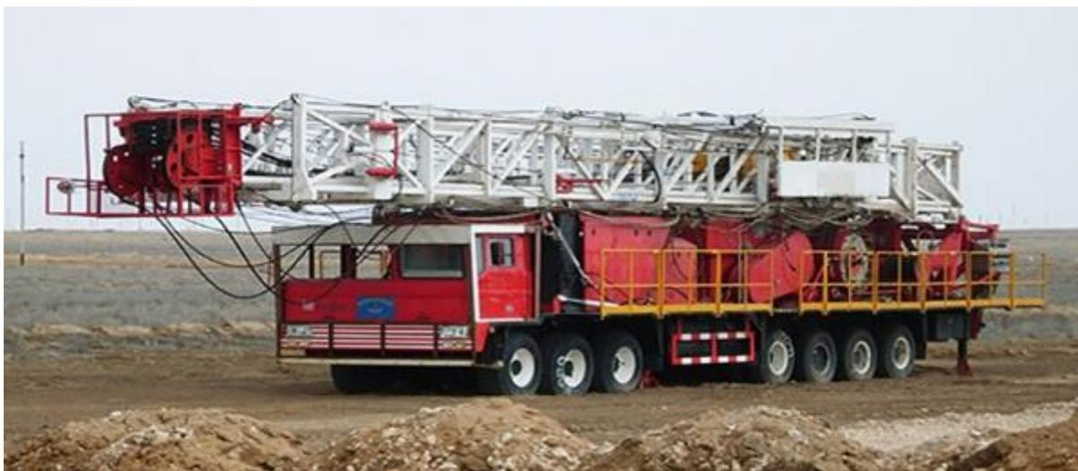
Рисунок 15 – Мобильная буровая установка Rig ZJ 40
