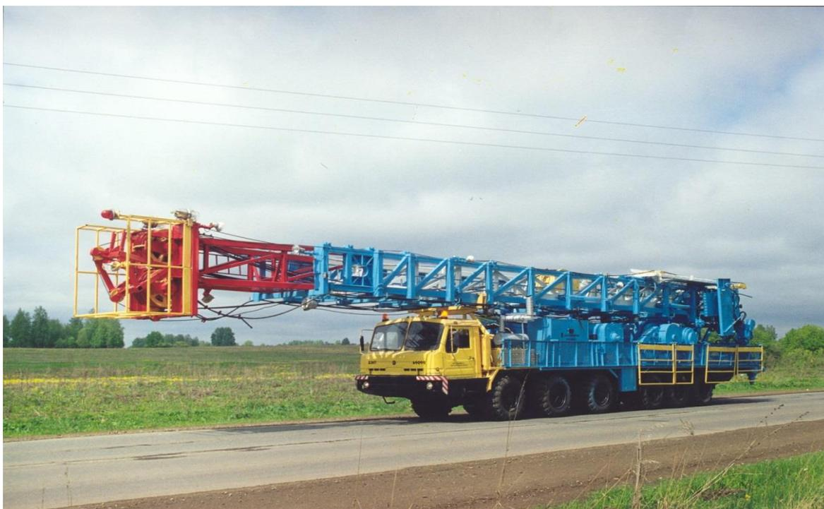
Рисунок 12 – Мобильная буровая установка 125
