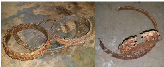
Рис. 4. Коррозионное разрушение уплотнительных колец из стали 20X13
