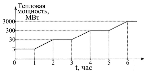
Рис. 6. Регламент 6: нормальный пуск с поэтапным увеличением мощности
