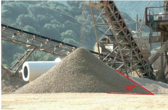
Рис. 5. Форма поверхности и угол естественного откоса гравия
