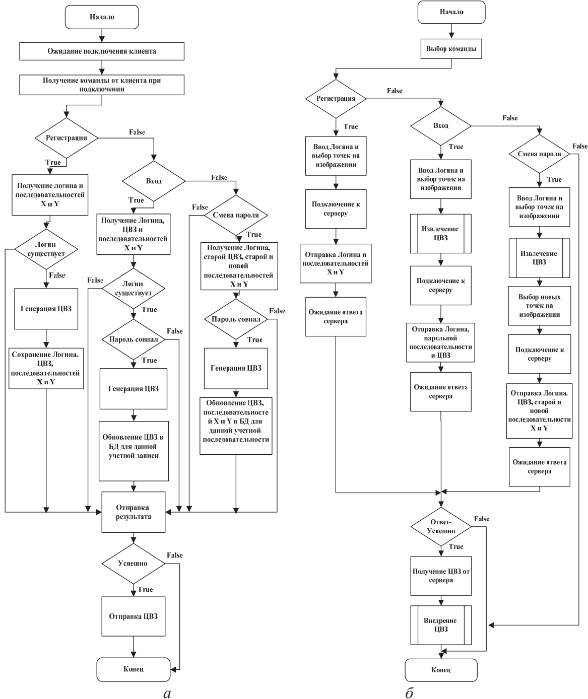
Рис. 4. Блок-схема алгоритма работы системы графического пароля на основе графического файла со множеством деталей: а) сервер; б) клиент
