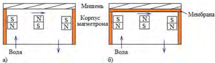
Рисунок 1.4. МРС с прямым (а) и косвенным (б) охлаждением мишени.
