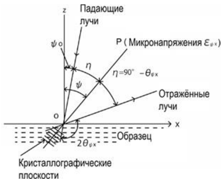
Рисунок 2.7. Дифракция лучей при изучении материала с остаточными напряжениями [67].
