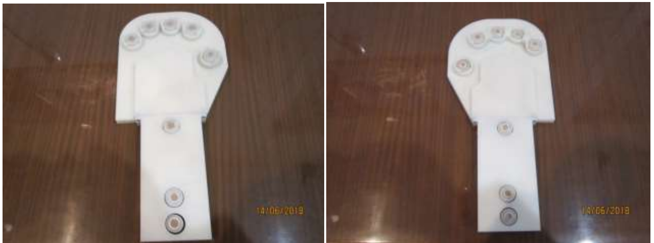
а) устройство для наложения левой руки, б) устройство для наложения правой руки
