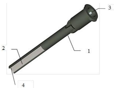
Рисунок 1.1. Композитный углеродсодержащий электрод, изготовленный по методике «литье под давлением» (Томск, ООО «Томьаналит»). 1 — полиэтиленовый корпус; 2 — электропроводящая смесь термостабилизированного полиэтилена высокого давления (70%) и технического углерода марки N220 (30%); 3 — контакт; 4 — рабочая поверхность.
