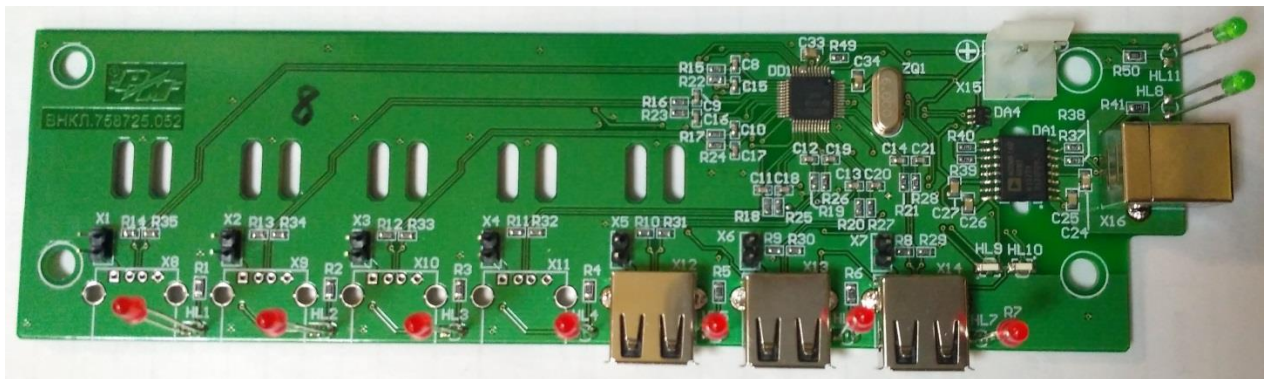
Рисунок Д.2. Технологический USB-концентратор с защитой от импульсных помех.
