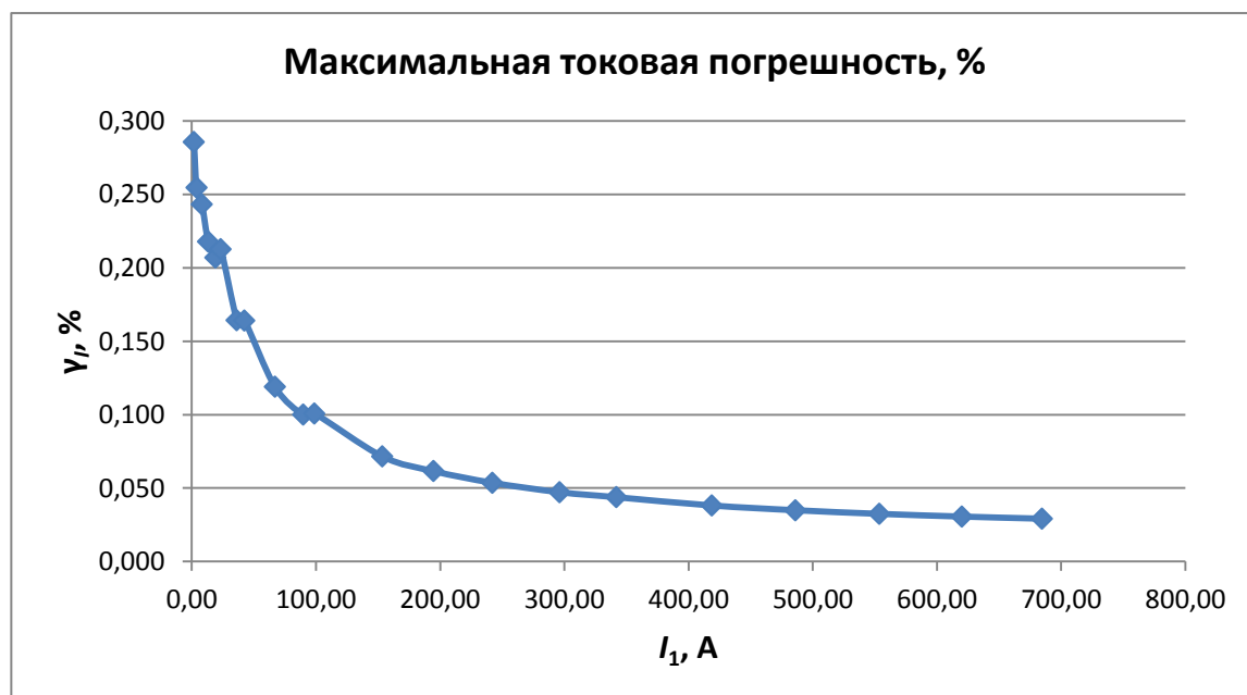
Рисунок 2.29. График зависимости максимальной токовой погрешности ТТ от первичного тока (метод холостого хода).
