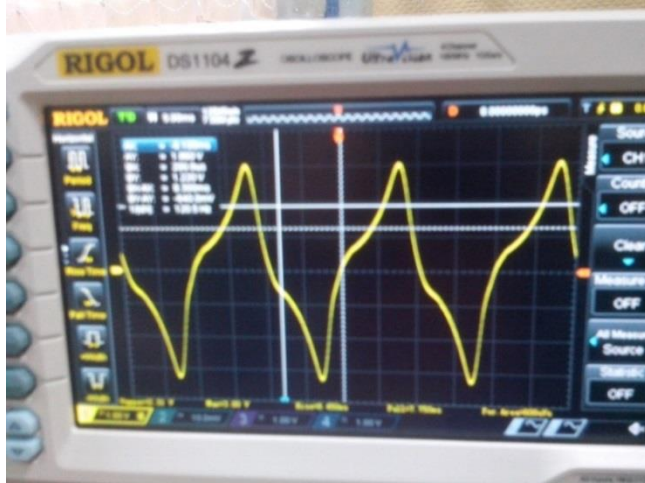
Рисунок Б.4. ЭДС дополнительной обмотки в режиме холостого хода при I_1=200 мА.
