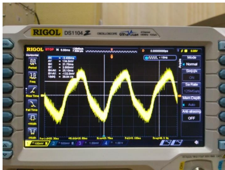
Рисунок 2.27. Осциллограмма напряжения на вторичной обмотке при токе холостого хода 70 мА.
