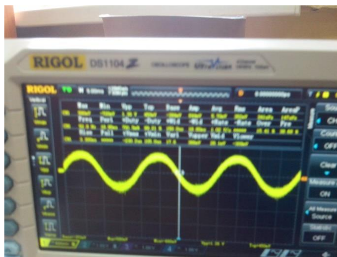
Рисунок В.4. Напряжение на токоизмерительном шунте при U_2=2 В.
