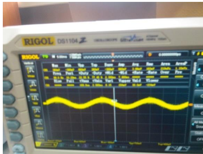
Рисунок В.2. Напряжение на токоизмерительном шунте при U_2=0,5 В.
