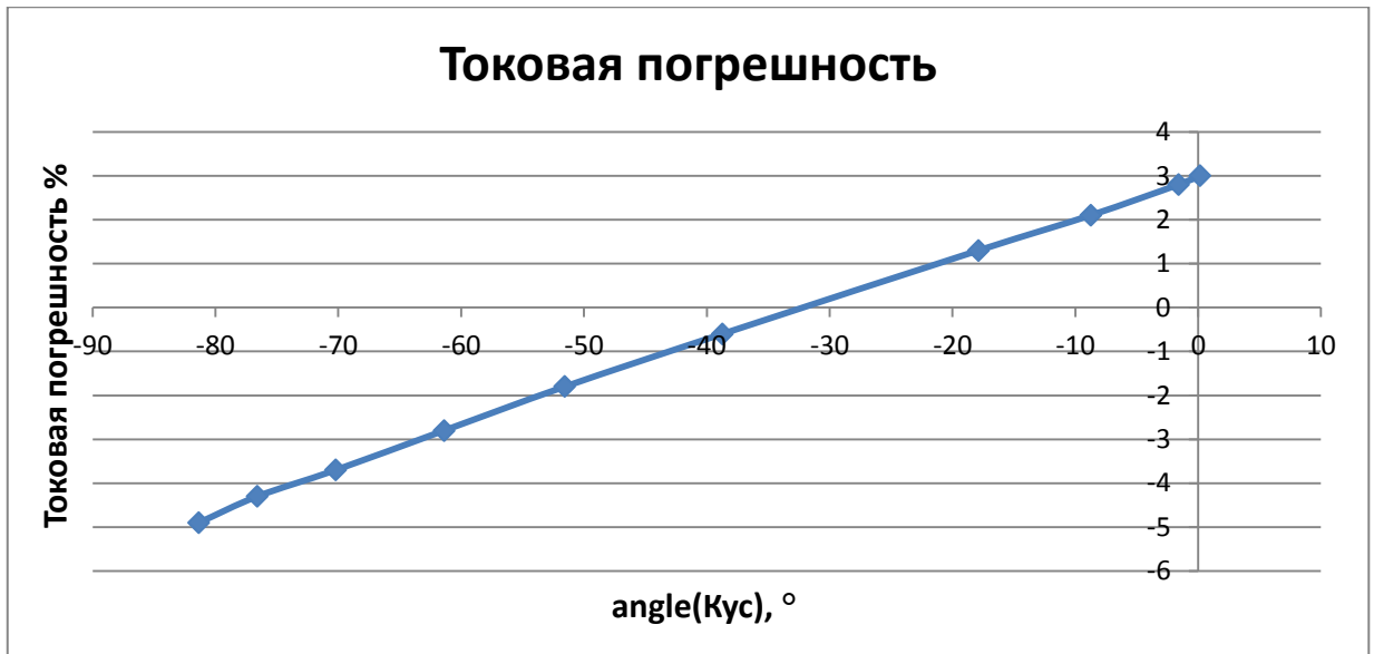
Рисунок 2.14. Зависимость токовой погрешности АТТ от фазового сдвига усилителя при фиксированном коэффициенте усиления, равном 100.
