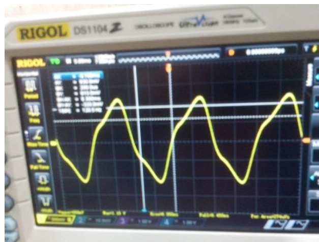
Рисунок Б.3. ЭДС дополнительной обмотки в режиме холостого хода при I_1=150 мА.
