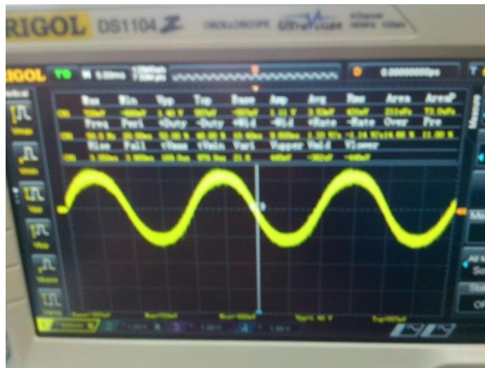
Рисунок В.5. Напряжение на токоизмерительном шунте при U_2=3 В.
