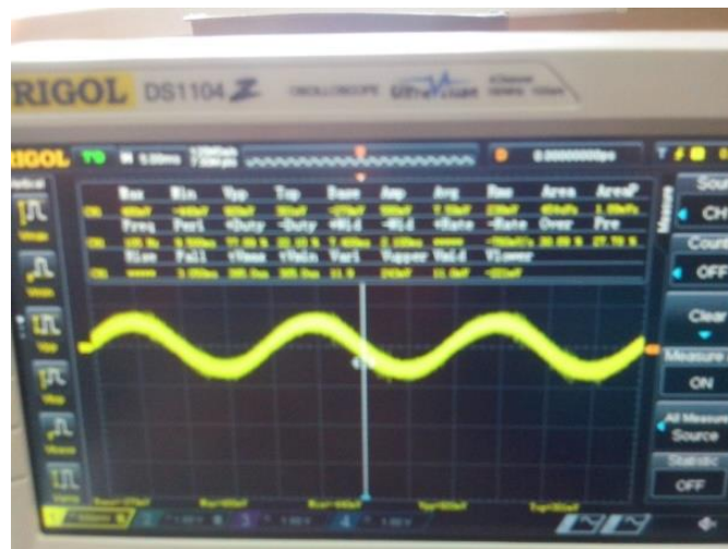
Рисунок В.3. Напряжение на токоизмерительном шунте при U_2=1 В.
