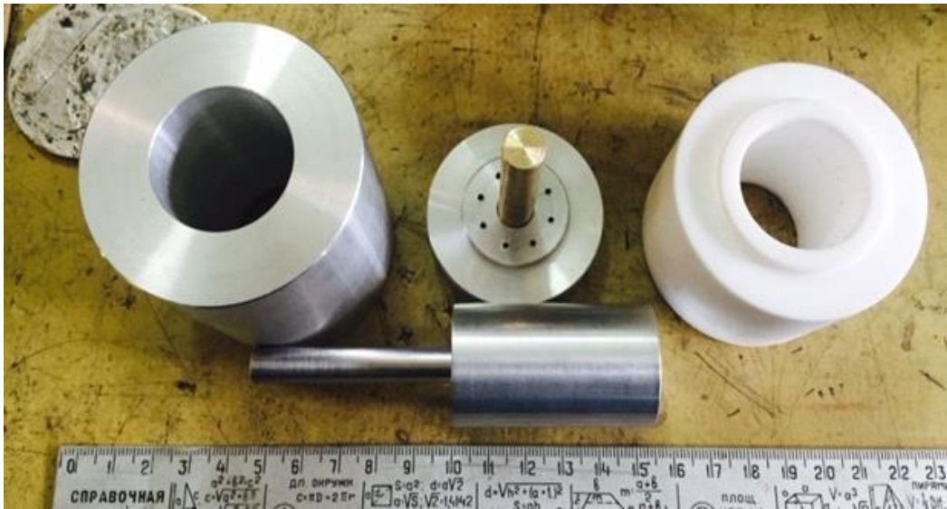
Рисунок 3.2 – Общий вид пресс-форм для изготовления образцов ВЭМ
