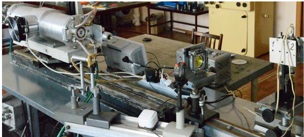
Рисунок 3.8 – Общий вид экспериментальной установки на основе CO 2 -лазера
