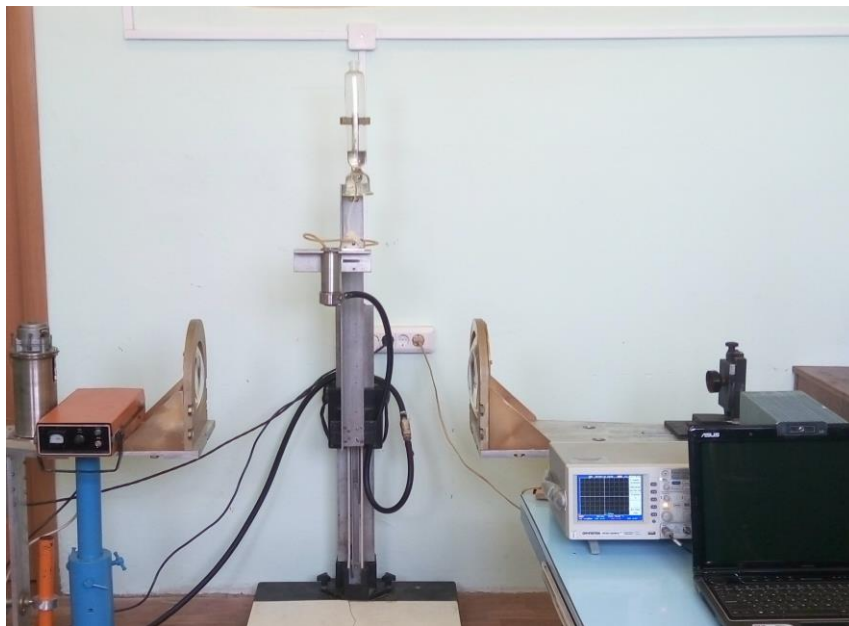
Рисунок 4.9 – Общий вид экспериментальной установки для определения структуры факела распыла
