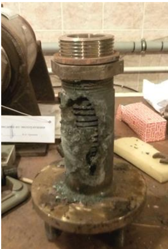
Рисунок 5.7 - Прогоревший кожух печи нагрева газа
