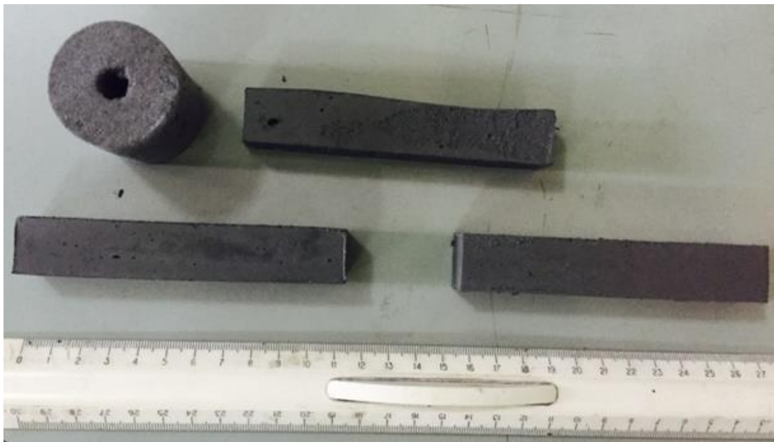
Рисунок 3.5 – Общий вид экспериментальных образцов зарядов ГРД
