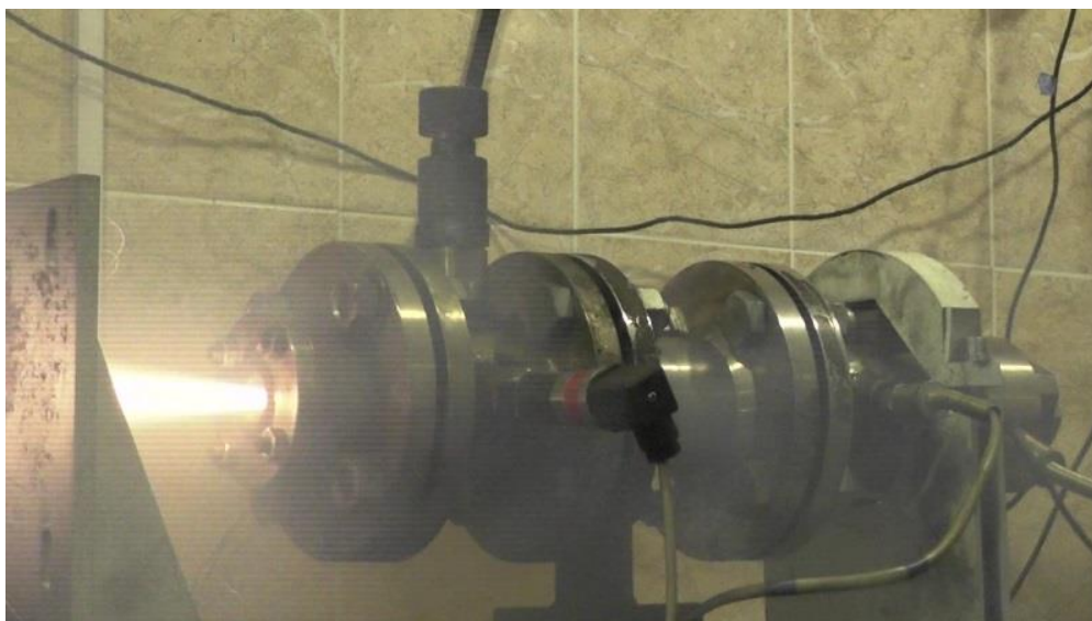
Рисунок 5.12 – Процесс горения образца ТГМ в струе продуктов горения газогенератора
