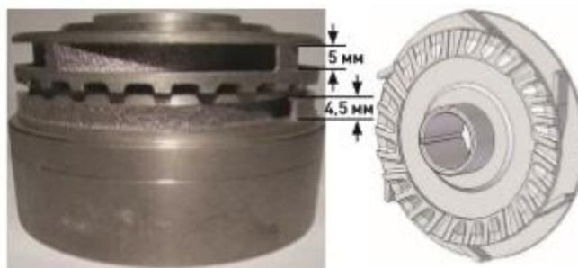
Рисунок 7 – Рабочая ступень с расширенным проточным клапаном
