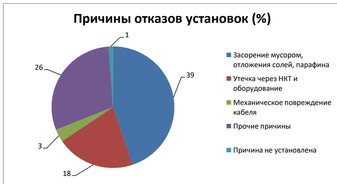
Рисунок 4.1 – Причины отказов УЭЦН на Шингинском месторождении за 2018 год
