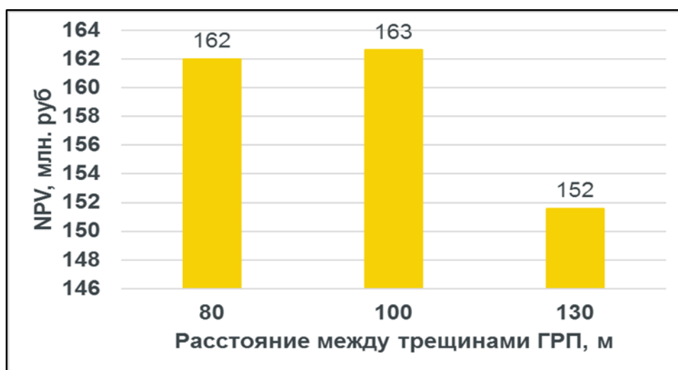
Рисунок 14 - Оценка экономического эффекта при различных расстояниях между трещинами ГРП
