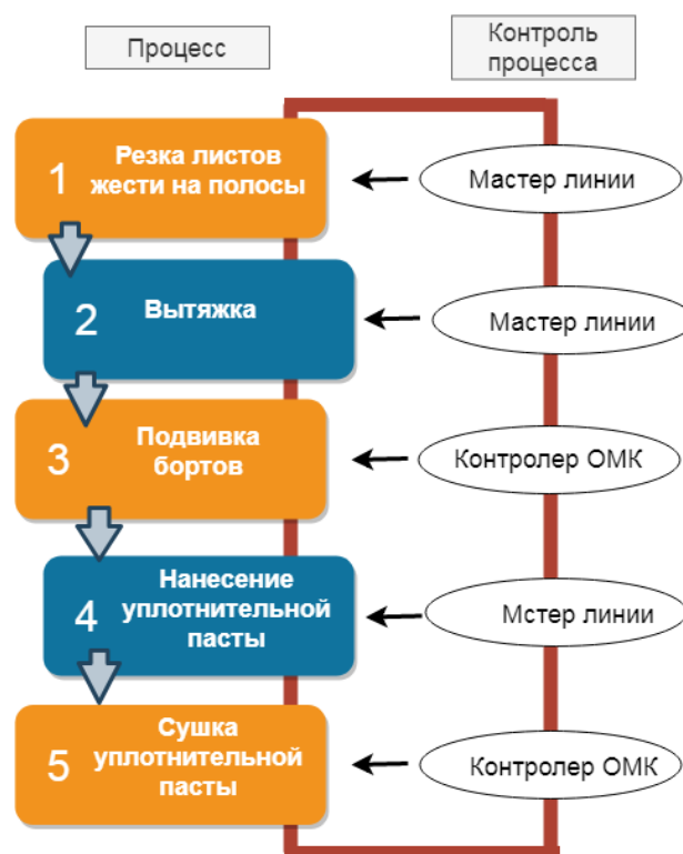
Рисунок 17 - Процесс изготовления концевых деталей
