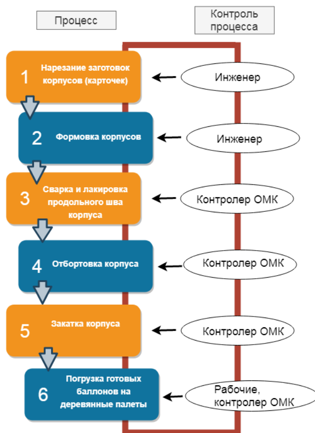
Рисунок 18 - Процесс изготовления жестяного баллона
