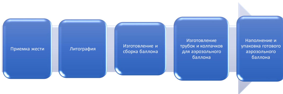
Рисунок 15- Этапы процесса производства аэрозольной продукции
