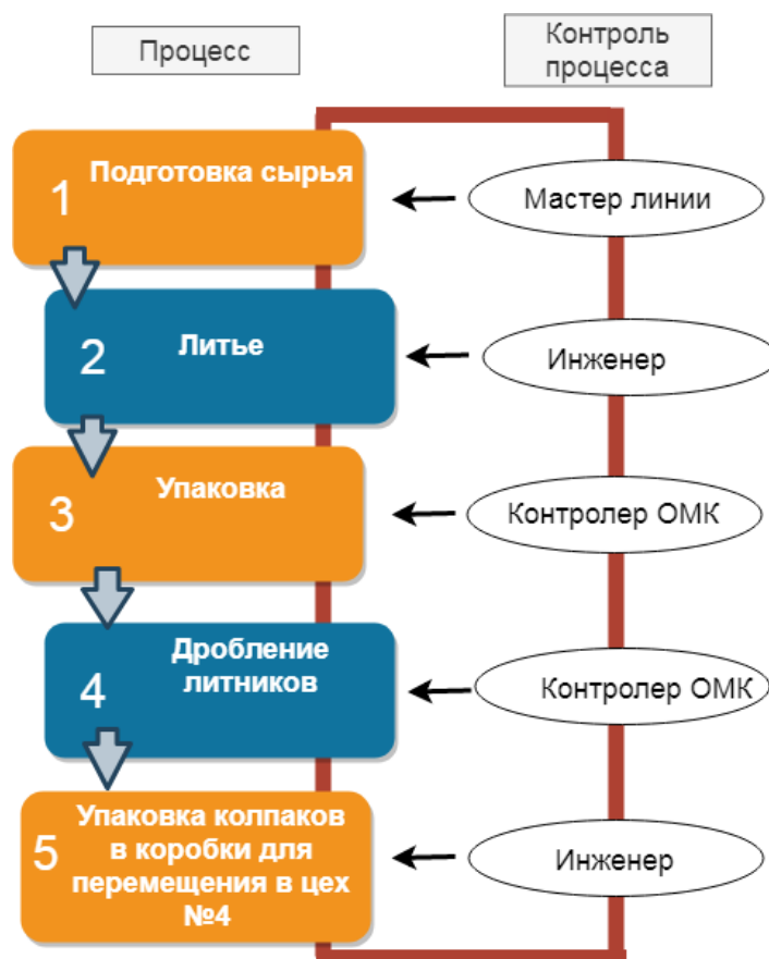
Рисунок 19 - Процесс изготовления трубок и колпачков для аэрозольного баллона
