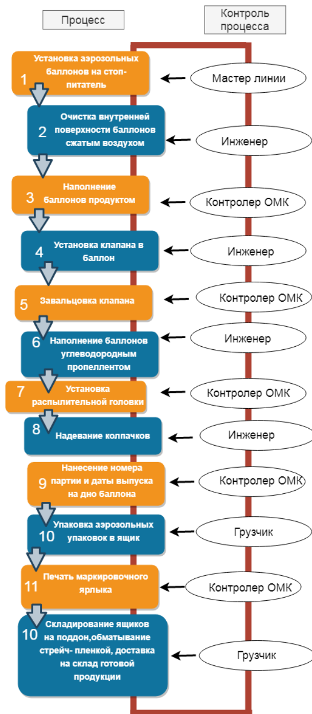
Рисунок 20 - Процесс наполнения и упаковки аэрозольного баллона
