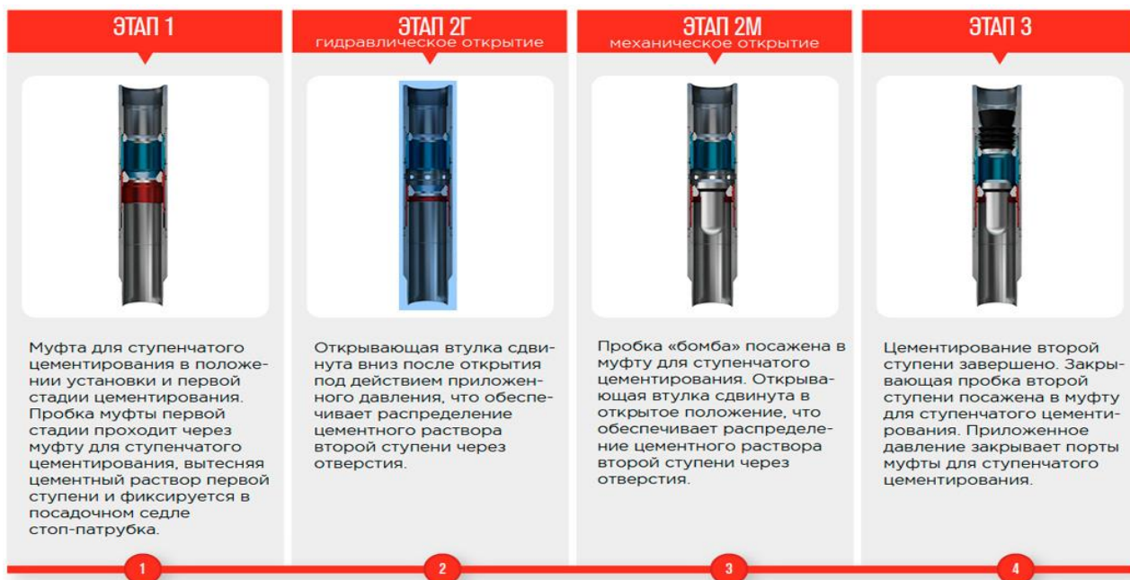
Рисунок 16 – Рабочие этапы муфты ступенчатого цементирования
