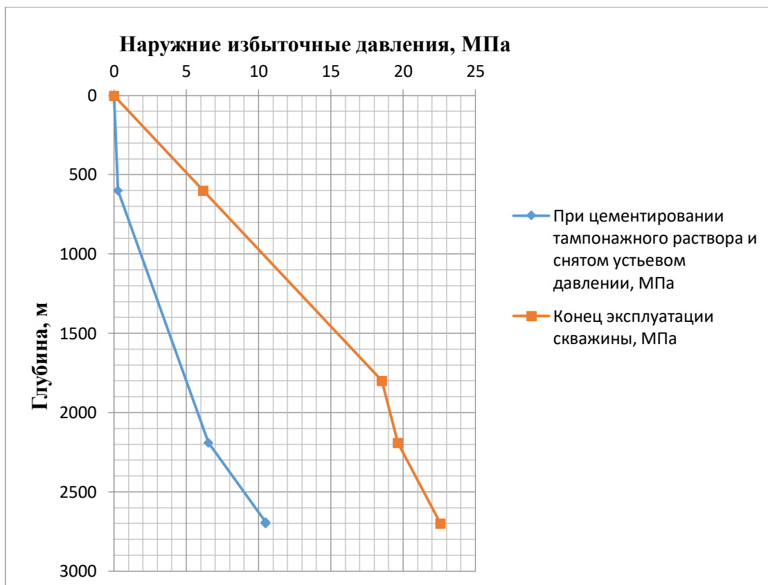
Рисунок 3 – Эпюры наружных избыточных давлений
