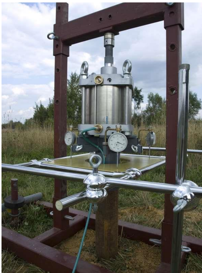
Рисунок 3.3 – Штамп ШВ-60 конструкции АО «Геотест» [63]
