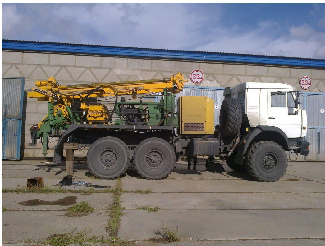
Рисунок 3.2 – Буровая установка ПБУ-2 на базе автомобиля КАМАЗ (фото автора)
