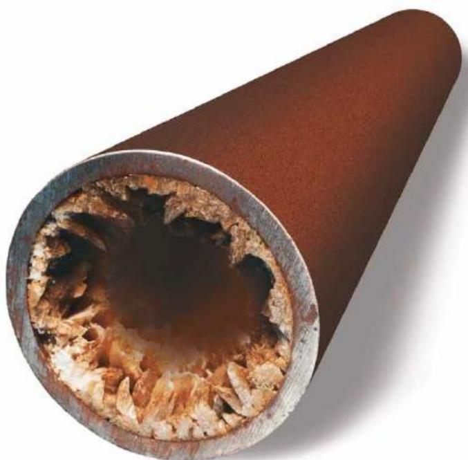
Рисунок 1.1 - Солеобразование в эксплуатационных колоннах
