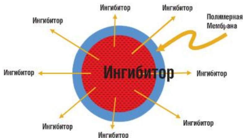
Рисунок 2.7 – Диффузия активного компонента ингибитора через полимерную мембрану
