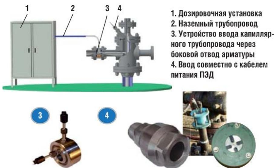
Рисунок 2.9 – Наземное оборудование
