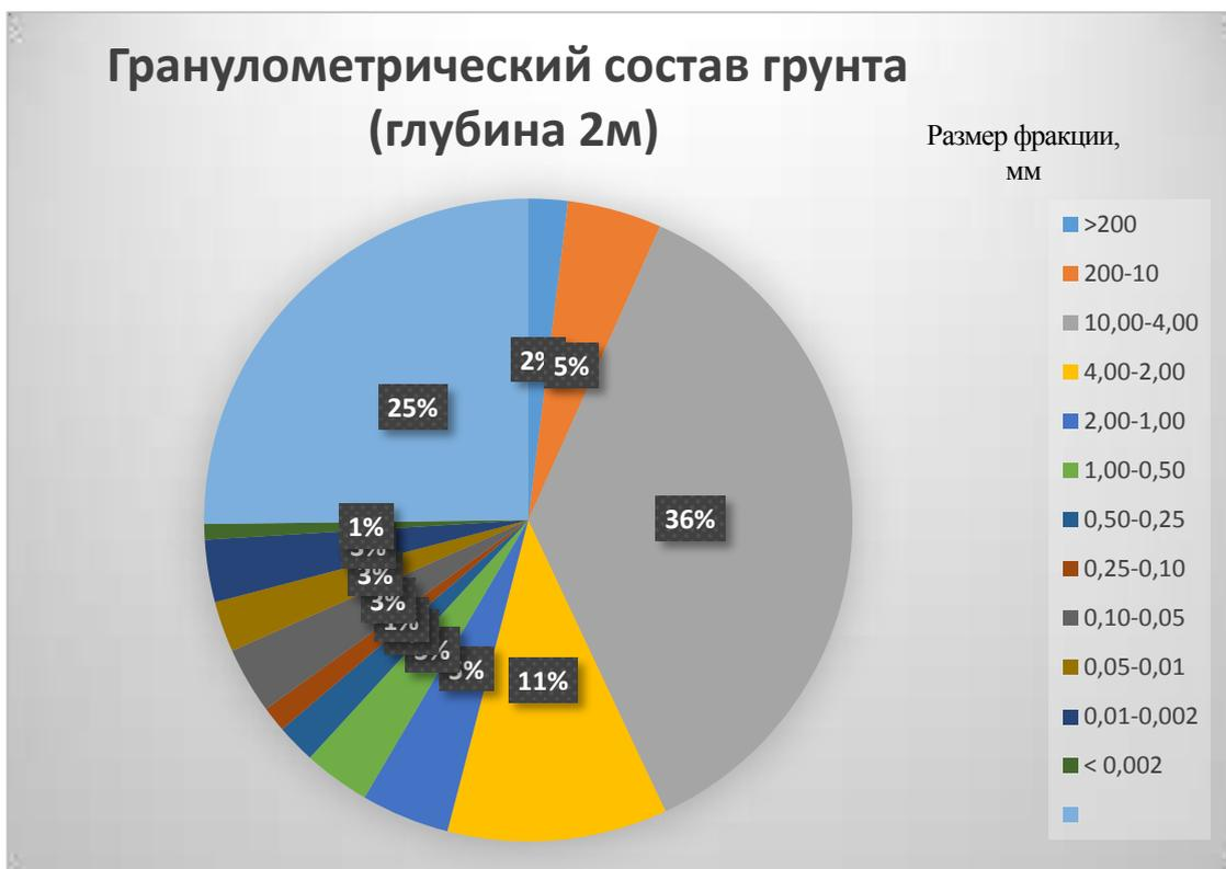
Рисунок 8 – Диаграммы гранулометрического состава грунта
