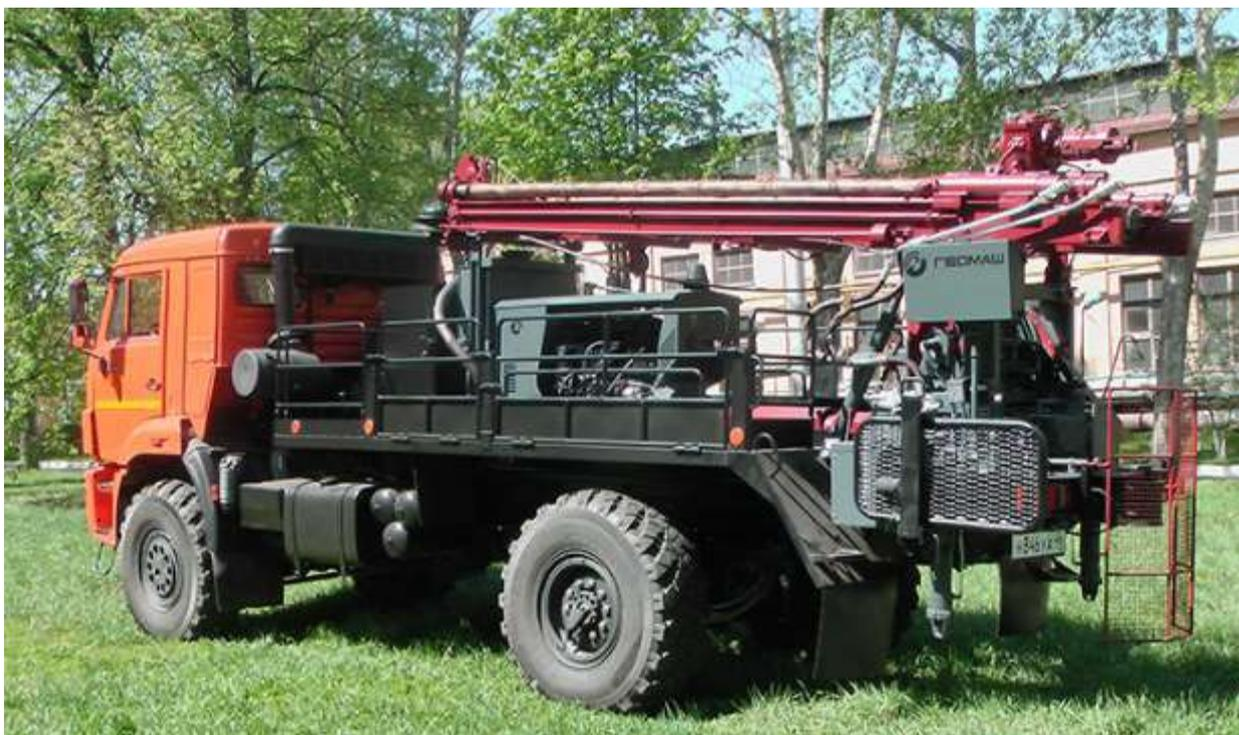
Рисунок 10 - Буровая установка ПБУ-2
