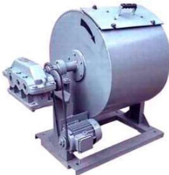
Рисунок 13 – барабан полочный КП 123 для определения истираемости
