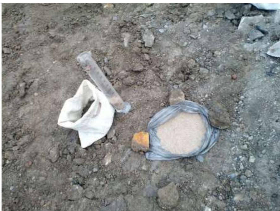
Рисунок 12 – Определение плотности методом замещения объема
