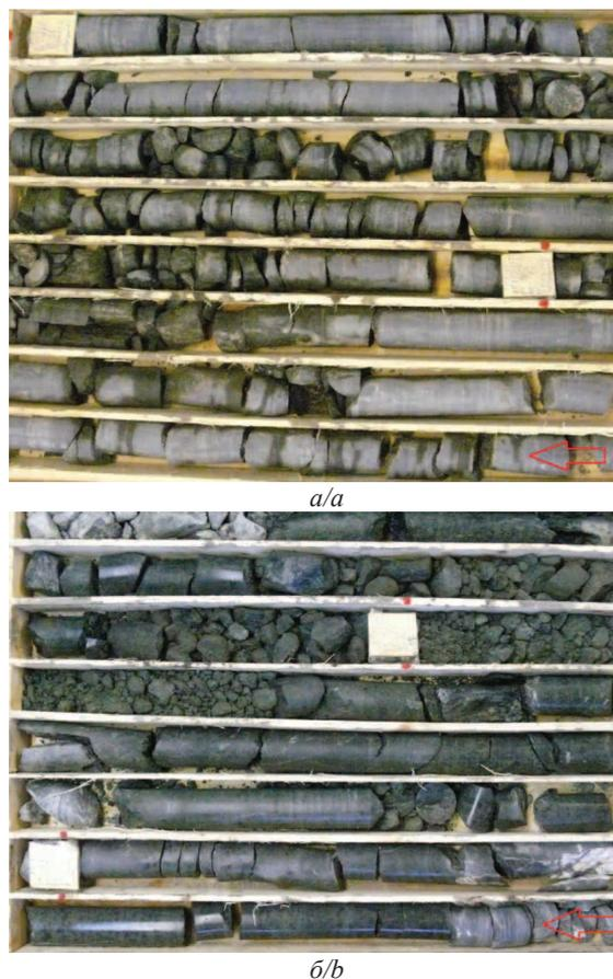
Рис. 3. Габбро-долериты, скважина РТ-11. Интервал отбора керна: а) 1547–1552; б) 1552–1557 м
