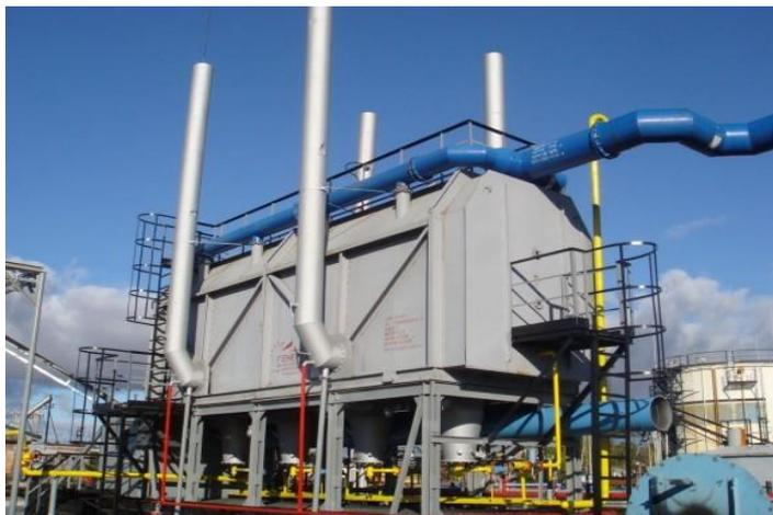
Рисунок 3 – Печь трубчатая блочная
