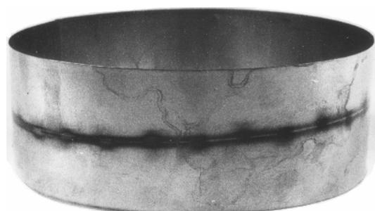
Рис. 4. Зависимость тока пучка от: ускоряющего напряжения (а); автограф на коллекторе из Al-фольги (б)
