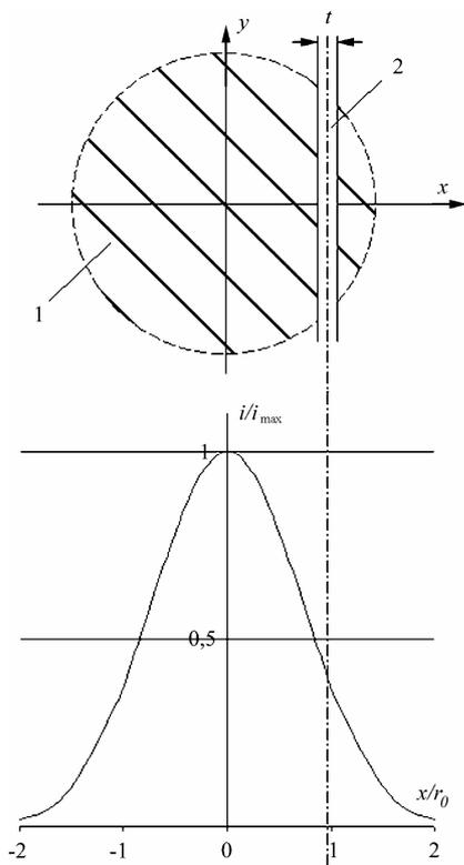
Рис. 7. Экспериментальная зависимость относительного щелевого тока от положения щели: 1) сечение пучка; 2) щель
