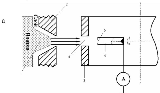
Рис. 5. Схема устройства для измерения распределения плотности тока в поперечном сечении центральной области ленточных пучков
