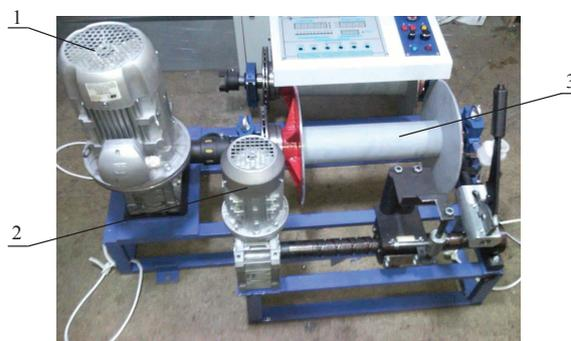
Рис. 1. Каротажный подъемник
