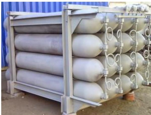
Рисунок 10 - Блок баллонов
