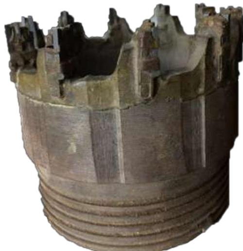
Рисунок 2.6 – Твердосплавная коронка М-2
