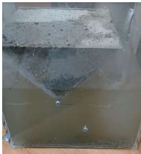
Рисунок 17 – Определение угла естественного откоса в водонасыщенном состоянии
