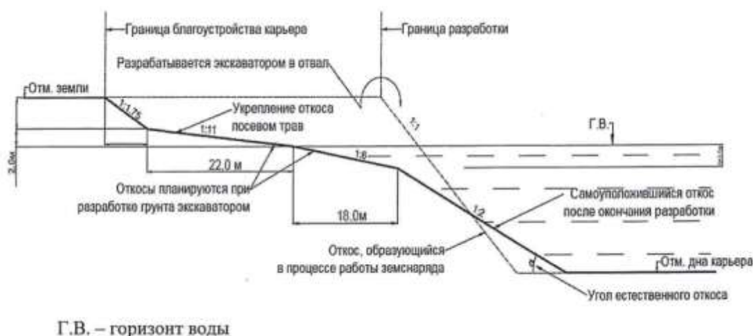
Рисунок 32 – Поперечный профиль рекультивируемого карьера рыбохозяйственного назначения [45]
