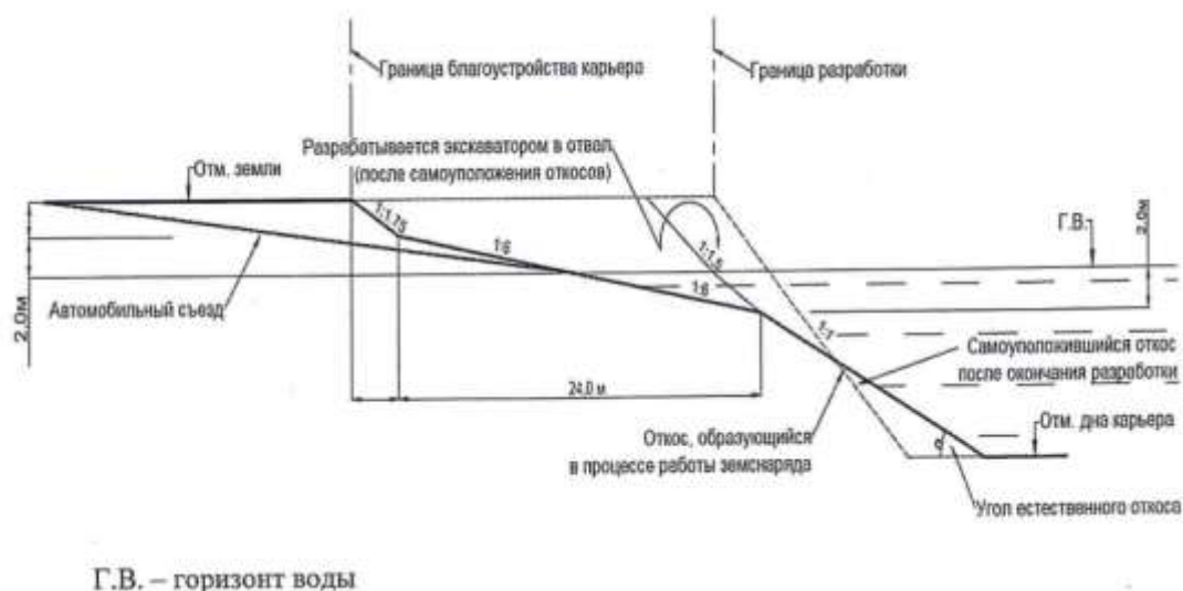
Рисунок 34 – Поперечный профиль водоема для технических нужд [45]
