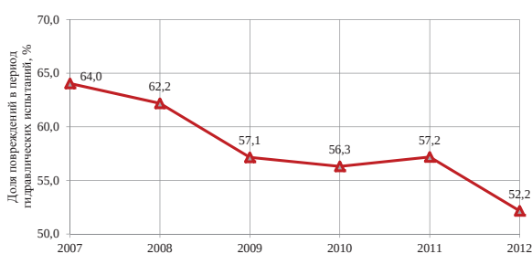
Рис. 3. Доля повреждений в период проведения гидравлических испытаний от общего количества повреждений (%)
