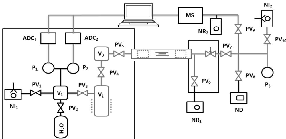
Рис. 2. Структурная схема установки для исследования коррозии графитов:  $\text{NI}_{1-2}$  – форвакуумные насосы;  $\text{PV}_{1-10}$  – клапаны;  $\text{P}_{1-3}$  – датчики давления;  $\text{V}_{1-3}$  – вакуумные камеры;  $\text{NR}_{1-2}$  – турбомолекулярные насосы;  $\text{ND}$  – магниторазрядный насос;  $\text{MS}$  – масс-спектрометр;  $\text{ADC}_{1-2}$  – аналого-цифровые преобразователи
