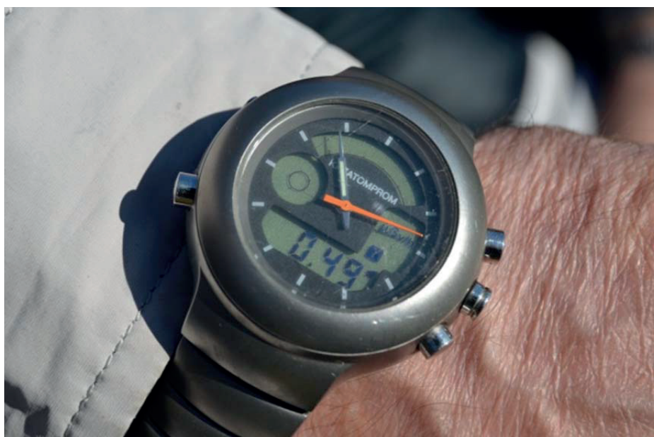
Рис. 4. Мощность экспозиционной дозы над ручьем в воздухе на высоте 1 м, мкЗ/ч
