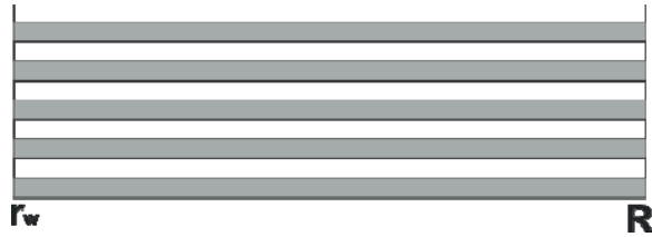
Рис. 1. Моделируемый пласт 5:5 (Белым – проницаемые пропластки, Серым – непроницаемые пропластки)
