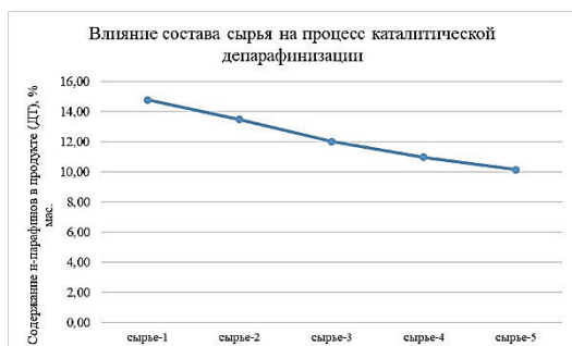
Рис. 4 – Зависимость содержания н-парафинов в продукте (ДТ) от состава сырья
