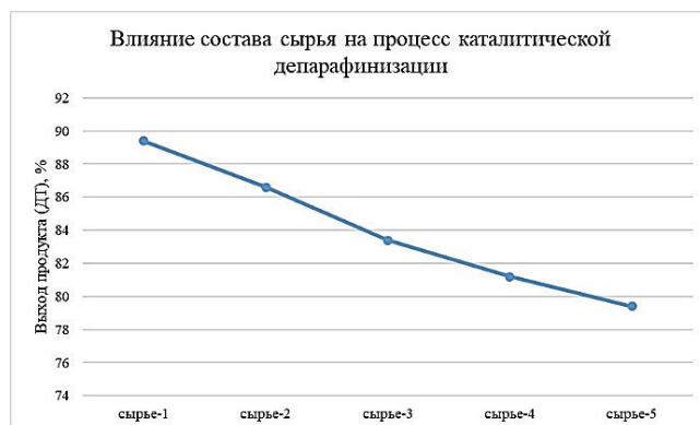
Рис. 6 – Зависимость выхода продукта (ДТ) от состава сырья
