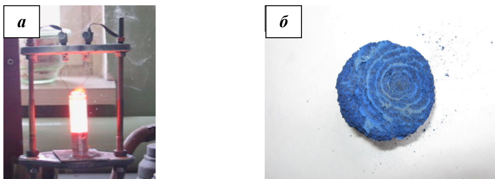
Рис.1. Режим послойного горения ( \varnothing 20 мм) -(а), винтообразная спиновая волна ( \varnothing 60 мм, поперечный разрез)-(б) пигмента системы \text{MgO-ZnO-CoO-Al}_2\text{O}_3 .
