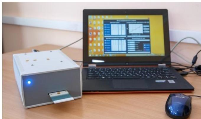
Рисунок 2 – Внешний вид цифрового цветометрического анализатора
