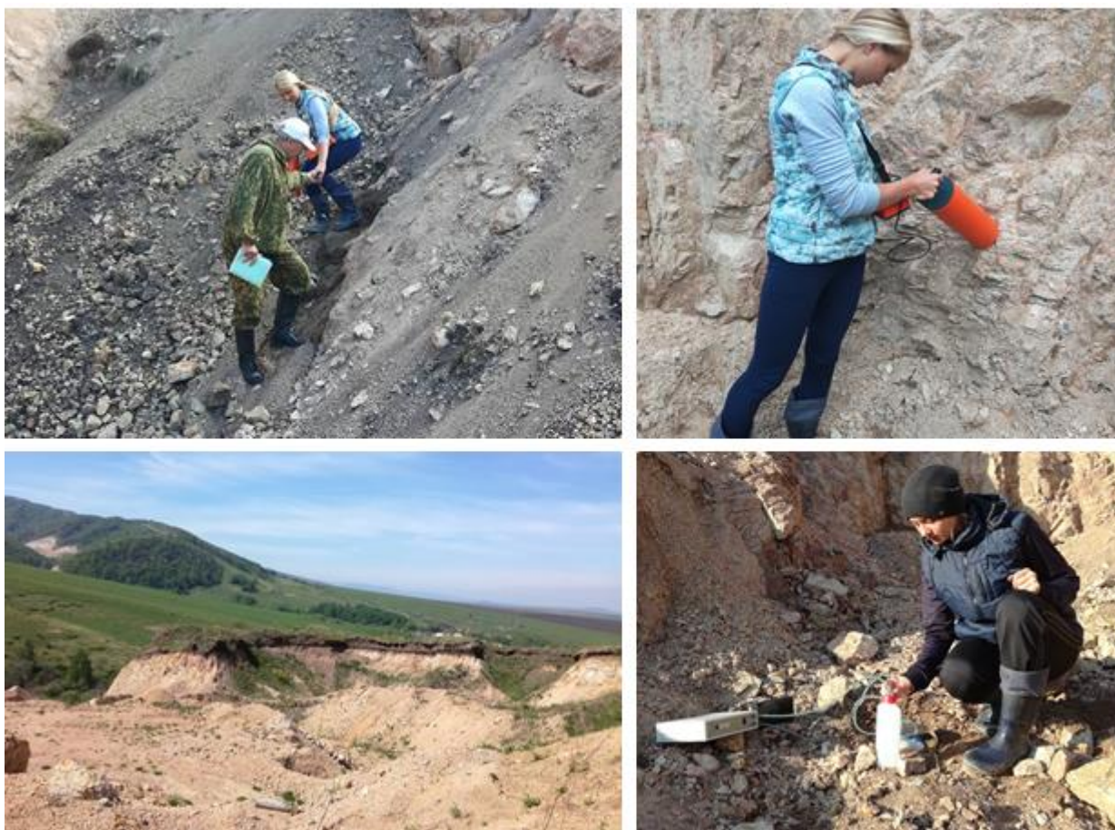
Рисунок 2.3 – Проведение гамма-спектрометрических и радонометрических исследований в районе г. Белокуриха, Алтайский край
