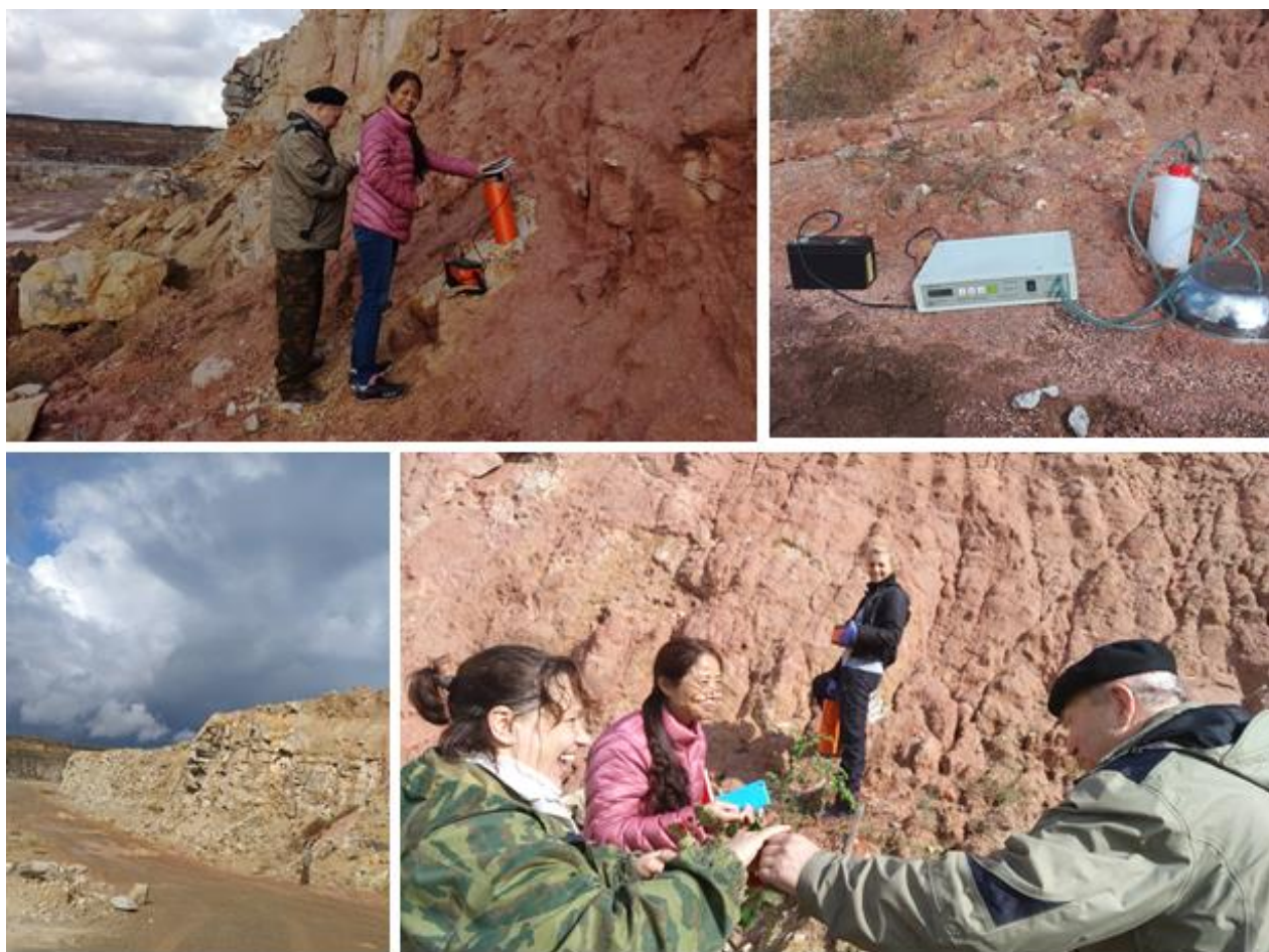
Рисунок 2.5 – Проведение гамма-спектрометрических и радонометрических исследований в районе пгт. Колывань, Новосибирская область
