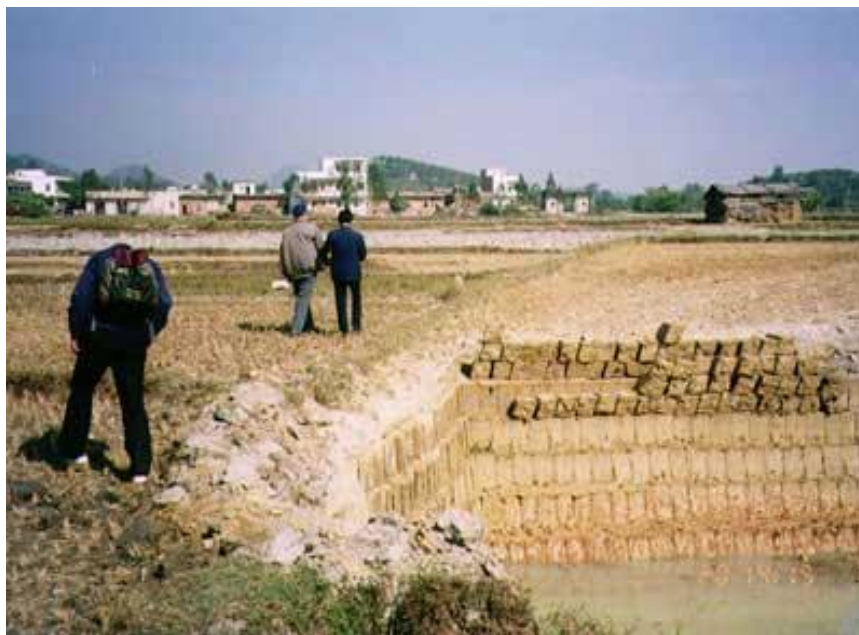
Рисунок 5.4 – Процесс заготовки материалов из местной глины для строительства в г. Чжухай, провинция Гуандун, Китай (Wang et al., 2012)
