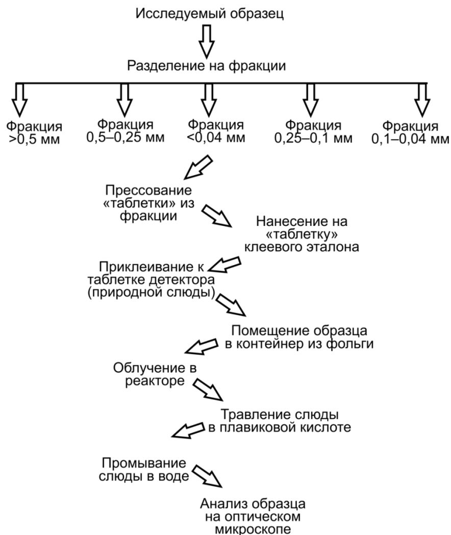
Рисунок 2.4 – Схема подготовки образца и анализ методом f-радиографии
